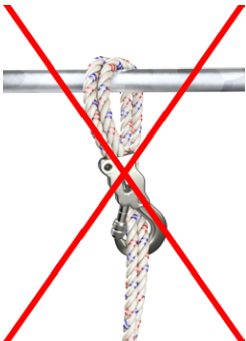
Abb. 79 Unsachgemäßes Anschlagen eines Reibungsfalldämpfers
